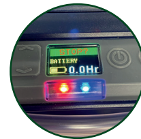
OLED-Vollfarbdisplay mit roten/blauen LED-Lampen zur Pumpenstatusanzeige, aus einigerem Abstand erkennbar
