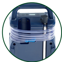
O mastro e o tubo de amostragem são instalados na bomba, durante o uso e transporte
