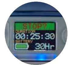
Il display colorato mostra la durata residua della batteria
