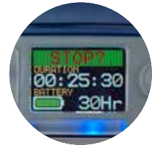
Pantalla con códigos de color que muestra la autonomía de la batería
