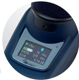
Il display intelligente mostra le ore rimanenti di durata della batteria e la capacità di memoria
