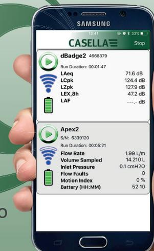
Avviamento, arresto e monitoraggio il dosimetro da remoto tramite un dispositivo iOS o Android.
