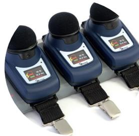
Les chargeurs 3 triphasés peuvent être raccordés ensemble et servir également de station de télécharge
