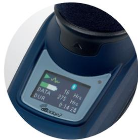
Das intelligente Display zeigt die verbleibende Dauer der Batterielaufzeit und die Speicherkapazität an
