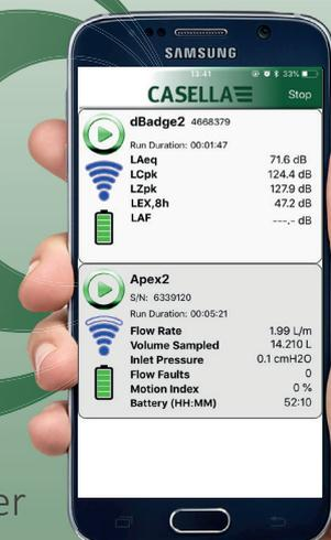
Starten, stoppen und überwachen Sie das Dosimeter aus der Ferne über ein iOS- oder Android-Gerät.
