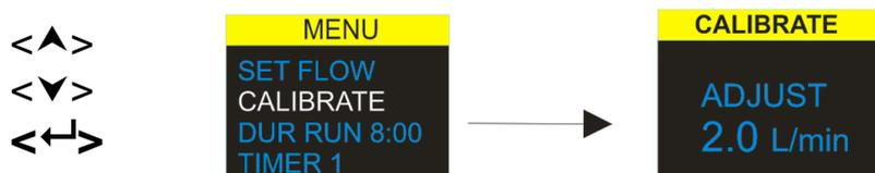
Для выполнения калибровки по одной точке прикрепите головку выборки и расходную трубу или другое расходно-измерительное устройство к соплу входного отверстия насоса, а затем выберите опцию для калибровки.
