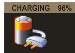
После указанного периода простоя экрана, экран зарядки погаснет. Можно «разбудить» экран нажатием кнопки питания для следующего интервала до перехода в состояние сна. При полной зарядке на 10 минут загорится голубой LED-индикатор, спустя это время насос отключится.
