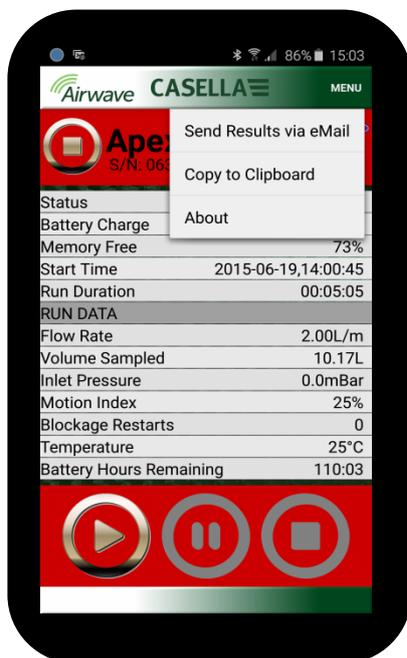
El MENÚ incluye diferentes opciones para facilitar la transferencia adecuada de resultados de medición a través del correo electrónico del dispositivo o de los servicios del portapapeles.
