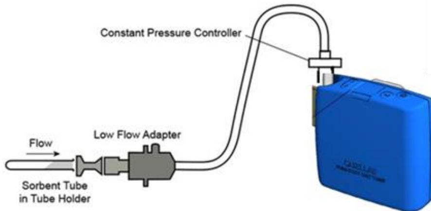
Este permite utilizar el instrumento con tubos sorbentes en caudales reducidos hasta 5 ml/min.
