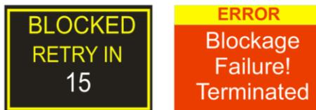
Reintento por bloqueo: Si la bomba no puede mantener el índice de caudal objetivo dentro del 5 % durante más de 20 segundos (por un tubo torcido o un bloqueo en la entrada), el muestreo se detendrá automáticamente. Después de un minuto, la bomba intentará volver a iniciarse. Si no consigue iniciarse después de realizar el número de intentos especificado, la bomba detendrá el proceso de muestreo en curso.
