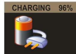
La pantalla de carga se apagará una vez transcurrido el tiempo de espera de pantalla especificado. Al pulsar el botón de encendido la pantalla «despertará» durante otro intervalo igual hasta que vuelva a apagarse. Cuando esté completamente cargado, aparecerá un LED azul fijo durante 10 minutos. Después, la bomba se apagará.
