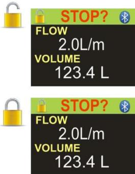
Pulse y mantenga pulsada la tecla Arriba y, a continuación, pulse rápidamente 3 veces seguidas la tecla <←> para acceder a las opciones de «BLOQUEO».
