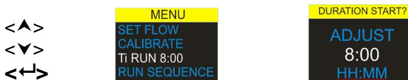
Con el **temporizador de duración de sesión** la bomba puede realizar muestreos durante un período definido para después apagarse automáticamente una vez transcurrido el tiempo especificado. (Modelos Plus y Pro)
