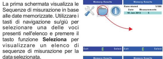
La prima schermata visualizza le Sequenze di misurazione in base alle date memorizzate. Utilizzare i tasti di navigazione su/giù per selezionare una delle voci presenti nell'elenco e premere il tasto funzione **Selezione** per visualizzare un elenco di sequenze di misurazione per la data selezionata.
