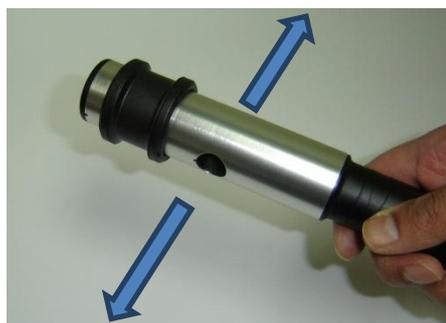
Se il campionamento avviene attraverso un adattatore gravimetrico, in particolare a concentrazioni elevate, si consiglia di orientare la sonda su un'asse orizzontale come mostrato in figura. Ciò permette alla polvere di passare attraverso la camera di campionamento riducendo il rischio di contaminazione ottica. Se la sonda è allineata verticalmente, vi è un maggior rischio di "precipitazione" del materiale particolato a causa della gravità e del successivo calo all'interno della sonda.
