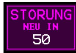
Nach einer Minute versucht die Pumpe, neu zu starten. Wenn die Pumpe nach der festgelegten Anzahl von Neustartversuchen nicht neu starten kann, beendet die Pumpe den aktuellen Probenahmelauf und zeigt eine Fehlermeldung an.
