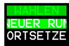
**Hinweis:** Wenn Sie **NEW RUN** wählen, werden die Laufzeit, Bewegungsindex und Volumendaten auf Null zurückgesetzt, und der Lauf wird als eine neue Messung in den Speicher eingegeben.
