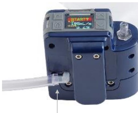
当使用采样泵来采集气体时，使用提供的鲁尔套头将气袋管连接到采样泵出口。
