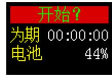
2. 检查电池电量，当采样泵不运行时显示为百分比，当采样泵正在运行时显示为剩余小时数（除了标准型 VAPex 会显示为百分比）。
