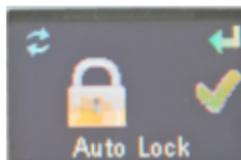
Para bloquear (y desbloquear) manualmente, pulse y mantenga pulsada la tecla derecha durante 2 segundos y, mientras mantiene pulsada esta tecla, pulse la tecla izquierda tres veces seguidas rápidamente.
