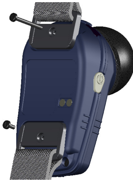
Orientamento corretto della vite Figura 25
